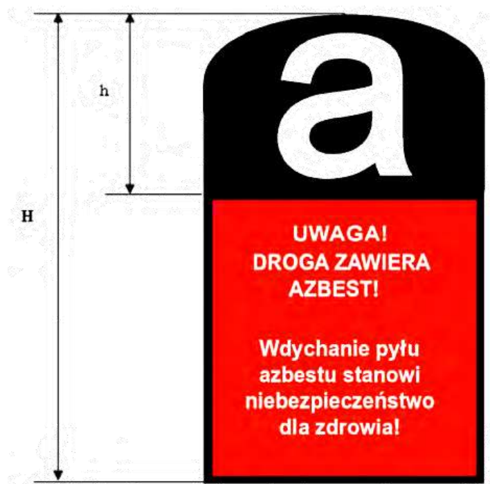
Rysunek 5 .Wzór oznakowania dróg utwardzonych odpadami zawierającymi azbest.
